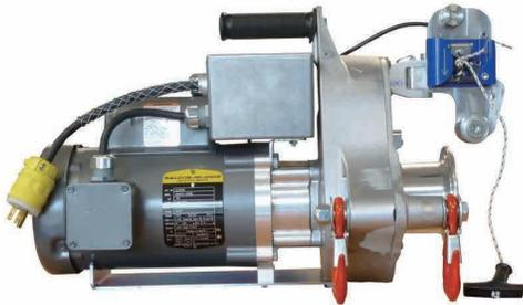
室内牵引作业用最为理想的选择之一，比如地下电缆牵引或设备起重只需牵引钢丝绳。它允许作业人员在安全负荷下抓住绳索牵引；**仅需轻拉绳索即可激活电动机转动牵引物体**，停止拉绳时，电动机停止工作，绞盘同时停转。它安全可靠，操作极为方便。
